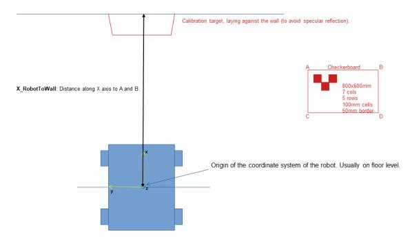
• Measure the X\_RobotToTarget (line 15) as:
